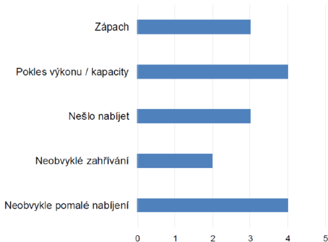
Nežádoucí projevy při nabíjení vedoucí k požáru
