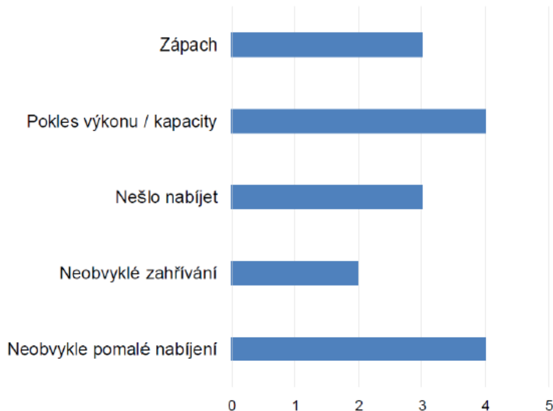
Nežádoucí projevy při nabíjení vedoucí k požáru
